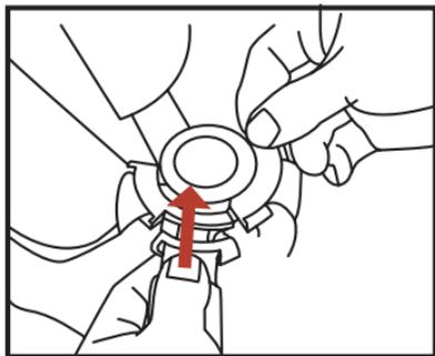
3- 어깨 벨트 및 허리 벨트 클립을 결합한 뒤, 왼쪽 클립을 왼쪽 버클에 화살표 방향으로 '찰칵' 소리가 날 때까지 밀어 넣어 체결합니다. 체결 후 단단히 고정되었는지 확인 합니다.
